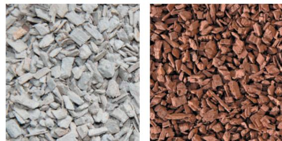
**Description** Remplissage de nivellement sec pour niveler les espaces creux ou les différences de hauteur qui doivent être adaptées
